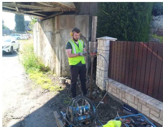
Foto 4: Průběh těžké dynamické penetrace
